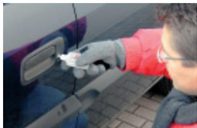
Blech anfrieren. Besonders wichtig ist die Schutzschicht an den Dichtgummis rahmenloser Seitenscheiben.
